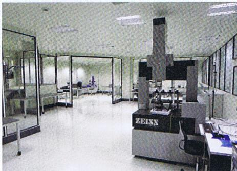
Die neue Messraumanlage besteht aus einem Feinmessraum der Güteklasse 2, einem Messraum der Klasse 3 für 3-Koordinaten-Messtechnik und einem Materialprüflabor. Diese wurden großzügig beplant, um die Messmaschinen wirken zu lassen. Die intelligente Lichtsteuerung über das eingebaute DALI-System verstärkt diesen Effekt.
