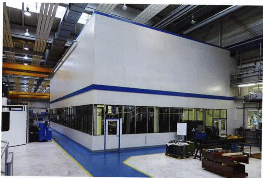
**Bild 2.** Um die erforderlichen Genauigkeitswerte von  $\pm 10 \mu\text{m}$  sicherzustellen, muss im Maschinenraum eine Temperatur von  $22^\circ\text{C} \pm 0,2 \text{ K/h}$  eingehalten werden. Diese klimatischen Bedingungen gewährleistet ein Präzisionsfertigungsraum mit Vortemperiererraum.
