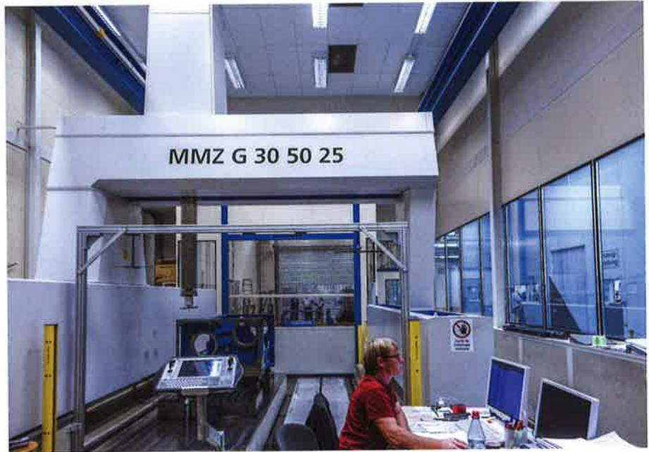
**Bild 3.** Messraum zur Qualitätskontrolle der gefertigten Präzisionsteile: Die Möglichkeiten schließen beispielsweise die „intelligente“, vernetzte Kommunikation zwischen der Zeiss-Messmaschine und dem Dixi-Bearbeitungszentrum ein.
